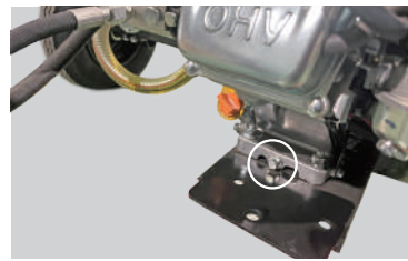
エンジンのドレンボルト モンキーレンチ等で外し、廃油する
