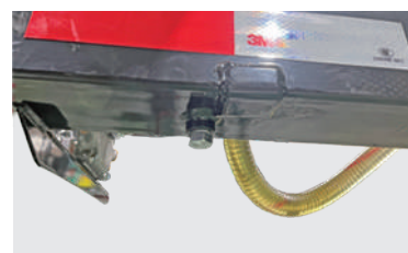
タンク底面にあるドレンボルト モンキーレンチ等で外し、廃油する
