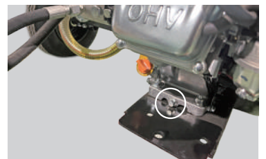
エンジンのドレンボルト モンキーレンチ等で外し、廃油する
