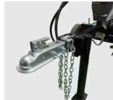
ラッチを倒し、ボルトとナットで固定し直す。
