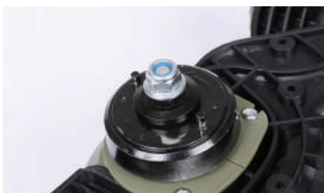
フランジナット (M8 × P1.25) 刃押さえ金具 緩み防止割つき
