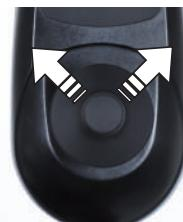
同じく左上斜め約45°方向に少し傾けると車いすはゆっくり左方向に進みながら大きく旋回をします。
