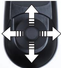
2 次にジョイステイックを右上斜め約45°方向に少し傾けます。すると車いすはゆっくり右方向に進みながら旋回をします。
