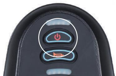
もう一度スイッチを押すと、「Thanks for using.(ご利用ありがとうございます。)」というアナウンスが流れ、バッテリインジケータと速度インジケータの表示が消灯します。
