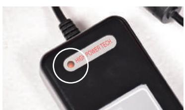
**6** ほぼ充電が終了すると、緑色のランプが点灯します。それから約1~2時間充電してください。バッテリが完全に充電されたら、電源を抜いてバッテリに繋いだコードも抜いてください。
