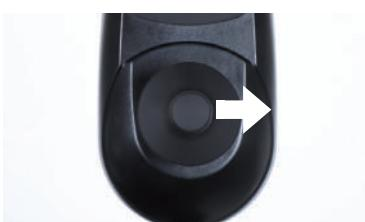
まだ、この段階では深く傾けないでください。急旋回してしまいます。手を放すと停止します。危険を感じたら手を放してください。
