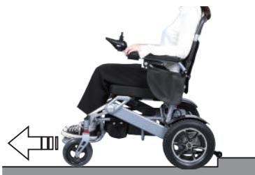
5 後進で段差を乗り越えるときにバランスを崩しやすく転倒のリスクが高まります。補助輪が衝撃を和らげるだけでなく、転倒のリスクを低減します。
