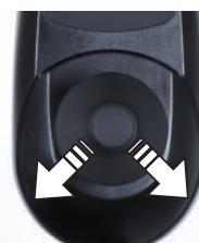
同じく左下斜め約45°方向に少し傾けます。すると車いすはゆっくり左後方に進みながら旋回をします。
