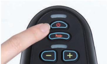
5 速度切替ボタンのーボタンを押し、速度インジケータの点灯を1つにします。この状態での最高時速は4kmとなります。※運転に慣れるまでは、この「低速」でご使用ください。
