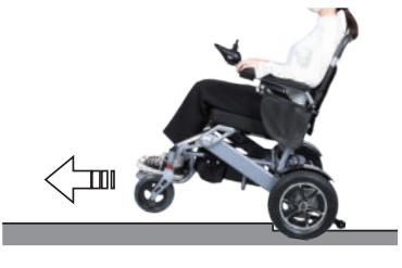
4 前進で段差を降りるときにバランスを崩しやすく転倒のリスクが高まります。補助輪が衝撃を和らげるだけでなく、転倒のリスクを低減します。
