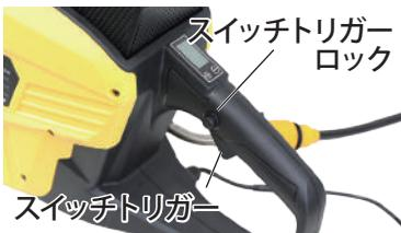
4 パネルの「+」「-」ボタンを押して回転数を調整します。
