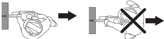
■ブレードを前後にゆっくり動かして、ブレードと切断材の接触面が小さくなるようにします。これによってブレードの温度が低下し、効率的に切断できます。
