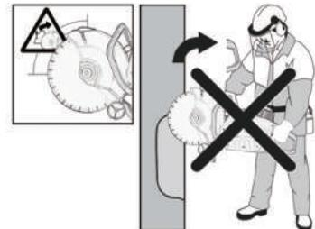
■完全に切断するときは、切断部が開いたままになるように、切削物を必ず支持してください。切断部が閉じていれば、キックバックは発生しません。切断部が閉じてブレードが挟まると、キックバックの危険性があります。
