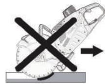
■ブレードに対して平行に立ちます。本機の真後ろに立たないようしてください。キックバックが発生した場合、ソーはカッティングブレードの水平面方向に動きます。
