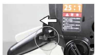
**3** シリンダー内の圧力を下げるためにデコンプボタンを押します。エンジンが起動すると自動的にコンプボタンは戻ります。
