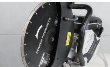
**2** 手袋をした状態で、ブレードとインナーフランジの間に手を入れて、ブレードを押し出すよう取外します。
