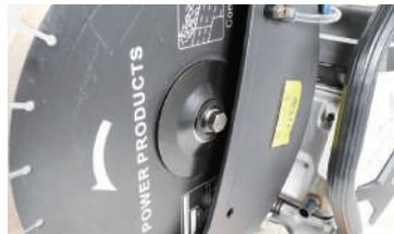
**5** 左側の穴から付属の六角レンチ等細長いものを挿して、ブレードを固定したまま、右側から付属のスパナでボルトを時計回りにゆっくりと締付けます。
