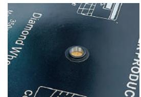
**3** ブレードの回転方向を確認して、シャフトに挿込みます。シャフトにブレードの中心穴が確実にセットされていることを確認します。
