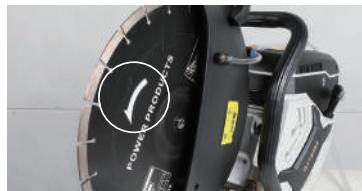
**4** アウターフランジの穴をシャフトにしっかりとはめてからワッシャを取付け、ボルトを手で仮留めします。
