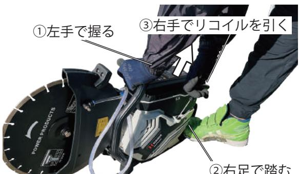
5 エンジンが始動したら、2～3分程度、暖気運転をします。ブレードが回転していないアイドル状態となります。
