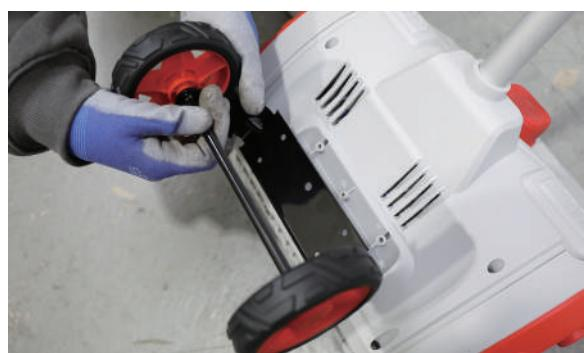
2 付属のネジとワッシャを4カ所の穴に通して、付属の工具で固定します。
