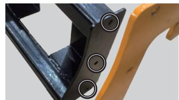
2 六角穴付きボルト③にワッシャ⑦を通して、ボルトのネジ部にネジゆるみ止め剤を1滴塗布します。その後、六角レンチ⑪で締付けます。
