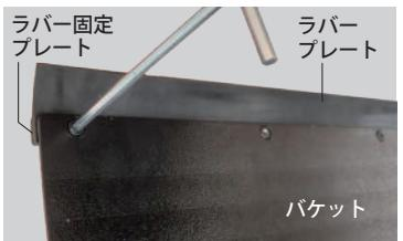
**4** 先ほど取付けたブラケット・固定プレートとバケットの取付穴を合わせます。
