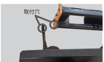
**5** 六角ボルト②にワッシャ⑥を通し、ボルトのネジ部にネジゆるみ止め剤を1滴塗布します。その後、ボルトを取付穴に通して六角ナット⑨を取付けます。スパナ⑬⑭でボルト頭とナットをそれぞれ固定しながら締付けます。
