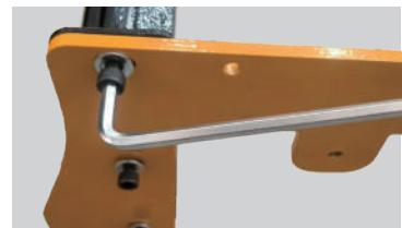
**3** 平ネジ①にネジゆるみ止め剤を1滴塗布します。次にバケットの穴にラバープレートとラバーフィクスの穴をネジ①で通して六角レンチ⑪で締付けます。
