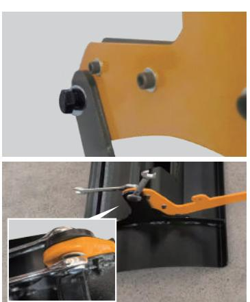
**6** 電動アクチュエータとブラケットを取付けます。ショルダーボルト⑤を接続箇所の両端の穴に取り付け、ワッシャ⑧を通し、ナット⑩を取付けます。ボルトのネジ部にネジゆるみ止め剤を1滴塗布し、ナットを締付けます。レンチ⑪とスパナ⑫を使用して締付けてください。
