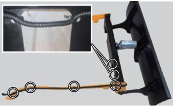
**9** 組立てたブレードの固定プレートとラジコン式エンジン草刈機(以下草刈機)を合わせます。(草刈機のブレーカーは必ずオフにしてください。)
