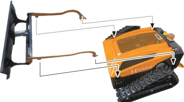
**10** 六角ボルト④にワッシャを通し、ボルト頭にネジゆるみ止め剤を1滴塗布し、スパナ⑫で締付けてください。
