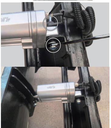
**7** 電動アクチュエータとバケットを取付けます。ショルダーボルト⑤を接続箇所の両端の穴に取付け、ワッシャ⑧を通し、ナット⑩を取付けます。ボルトのネジ部にネジゆるみ止め剤を1滴塗布し、ナットを締付けます。レンチ⑪とスパナ⑫を使用して締付けてください。
