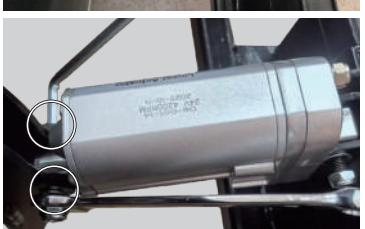
**8** 結束バンドを使用し、電動アクチュエータの配線を固定プレートに固定します。
