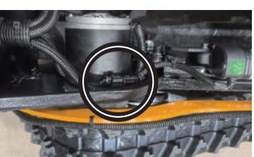
**14** 電動アクチュエータの配線端子を草刈機の電装ボックス右下の穴から通します。
