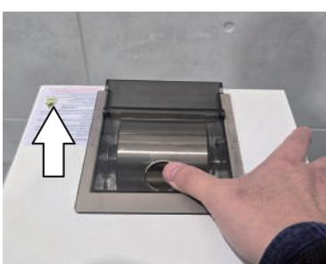
**3** ぬるま湯で冷却ローラーを洗い、氷を溶かしてから、乾いた布で拭きます。
