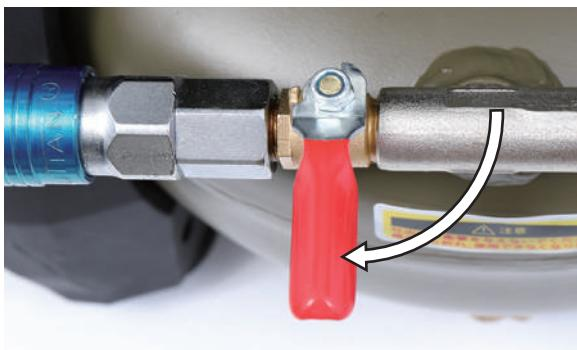
2 カプラーのリングをスライドさせるとエアホースが外れます。この時、ホース内のエアが完全に抜けきらない状態で行うと、エアホースが勢いよく外れる場合がありますので、完全にエアを抜いてください。また、念のためホース側も手で持つて行ってください。
