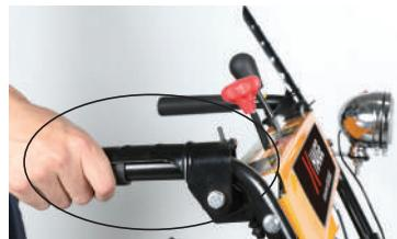
8 変速レバーで速度を変える場合は、走行クラッチレバー、除雪クラッチレバーから手を放してから操作します。
