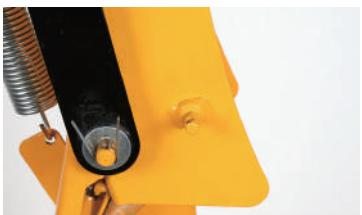
**3** 操作パネルのシュータデフレクタレバーより出ているワイヤ先端部を、シュータデフレクタの突起部にはめます。
