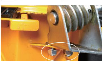
**4** ロッドガイドの長さ、傾きが調整できたら、手前のナットをスパナで固定しながら奥のナットをスパナで締付け固定します。
