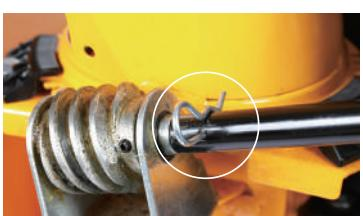
**3** ロッカーアームがギヤとロッドガイドと一直線になるようにロッドガイドの長さ、傾きを調整します。場合によってはギヤの下の固定ナットを緩めギヤも調整します。
