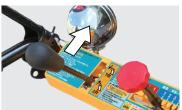
**2** シュータ先端(シュータデフレクタ)の突起部に仮留めしているワッシャ、割りピンを一旦取外します。
