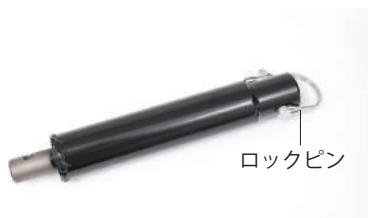
2 駆動軸に延長棒を挿込み、取付穴を合わせ、ロックピンを挿込みロックをします。
