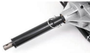
3 ドリルのロックピンを外し、延長棒に挿込み、取付穴を合わせます。
