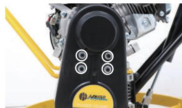
**2** ベルトを目視で確認します。※クラッチは自動調整式(パテント)になっているためベルトの張り調整は不要です。
