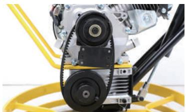
**3** ベルトがスリップし始めたら、クラッチの動作に異常がないことを確認し、ベルトの交換を行います。
