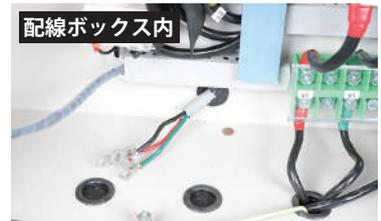
**4** 配線ボックス内のブレーカーを留める六角ボルトを6mmの六角レンチで取外します。
