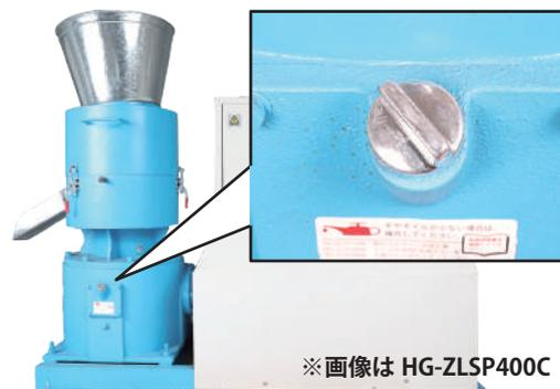
オイル給油キャップを抜差しして、オイル給油キャップに付いているゲージの上端にオイルが付くまで補給します。
