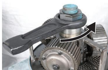
隙間は0.1mm～0.3mmになるように調整します。
