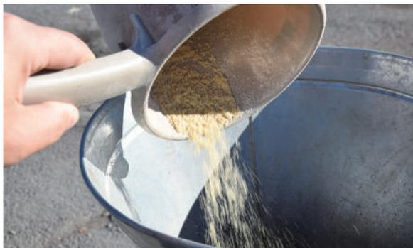
ローラーが左右均等に回っているか、原料の投入量がペレット成形速度より大幅に上回っていないかを、慣れるまで目視で確認しながら行ってください。
