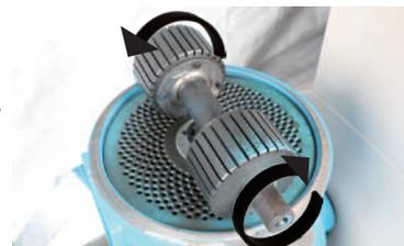
隙間間隔は0.1mm-0.3mmになるように調整してください。
