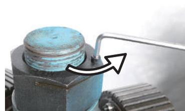
**4** 付属のレンチで調整ボルトを反時計回りに回し、取外します。
