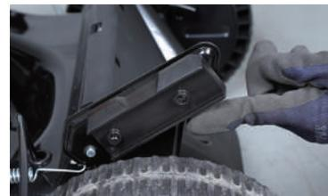
**2** 下ハンドル上部の取付穴にヘッドライトのボルトを通します。
