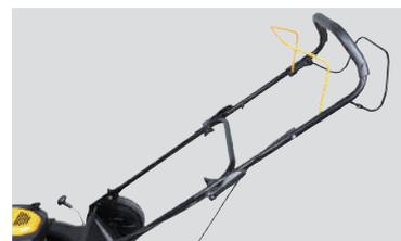
**6** ワイヤクリップで始動スイッチワイヤ、走行クラッチワイヤをハンドルに固定します。
