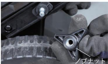
**4** ノブナットを押し気味に時計回りに回し締付けます。
