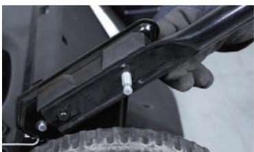
**3** スペーサーを取付け、ノブナットを取付けます。
