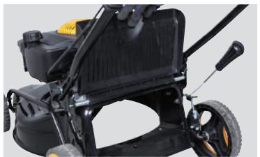
**2** 集草袋のフレームにある爪を後部排出カバーのシャフト(スプリング部分)にひっかけます。このとき、後部排出カバーを大きく開いてください。
