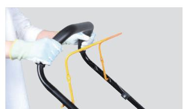
**2** エンジンが停止し、ブレードも停止します。
