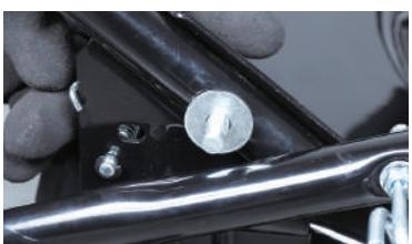
**4** ノブナットを取付け、押し気味に時計回りに回し締付けます。
