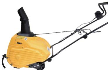
それでも、飛ばない場合は、レバーハンドルから手を放し停止させ、電源プラグを抜いてから、詰まった雪を雪かき棒で取除きます。
