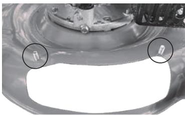
**2** 横排出ガイドを取付け、ノブナットで固定をします。
