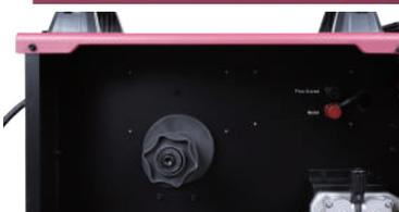
**3** ワイヤリールの穴をワイヤリールホルダーの突起に挿込みセットします。
