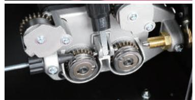
**2** ローラーを外すと両面に溝の径の刻印があります。1.0mm のワイヤを使用する場合は、1.0の刻印がある方を奥側にし挿込みます。
