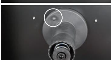
**4** ノブを取付け、反時計回りに回し締付けます。
