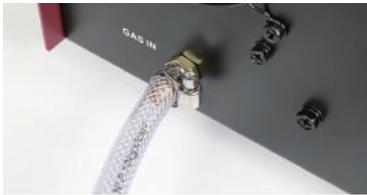
**3** ガスホースを市販のガス流量調整器に取付け、シールドガスのバルブを開け、漏れがないか確認します。
