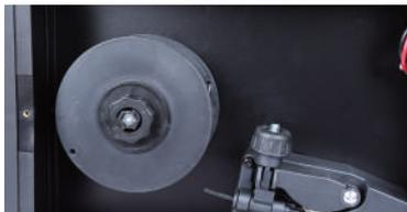
**4** フラックス入りワイヤの折れ曲がった先端部分を、ニッパ等で切断し、ガイドチューブに挿入します。
