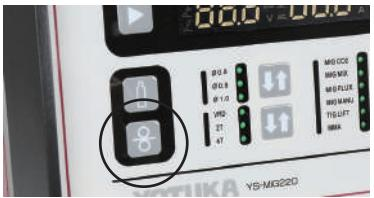
**5** ワイヤが出にくいようであれば先端のチップを取り外し、50mm程度ワイヤが出てきたら、トリガーから指を放します。
