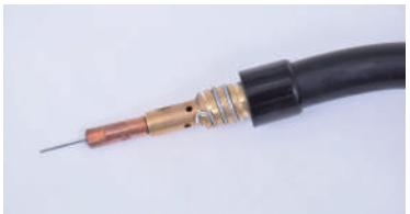
**7** トーチにノズルを取付けます。その後、ワイヤが10mm程度の長さになるよう、ニッパ等で切断してください。
