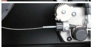
**6** ワイヤをローラーの溝に入れながらチューブに挿込みます。
