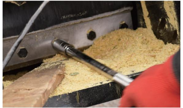
ボルトの頭にソケットレンチを強く押込んだままソケットレンチを回します。
