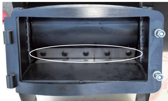
**2** ホッパーの底のブレード隙間調整板のボルトの緩みを確認し、緩んでいたら「必ず増し締め」をします。
