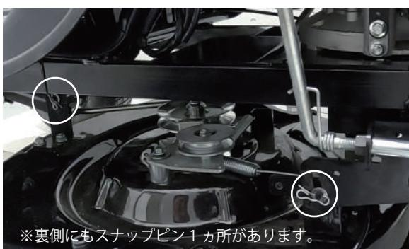
**4** 後方の暴れ防止棒を10mmのスパナで取外します。
