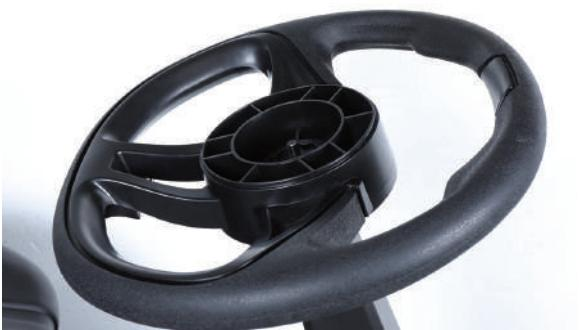
**9** 最後にハンドルカバーを取り付けます。3カ所のツメをハンドルの3カ所の穴に押し込みます。
