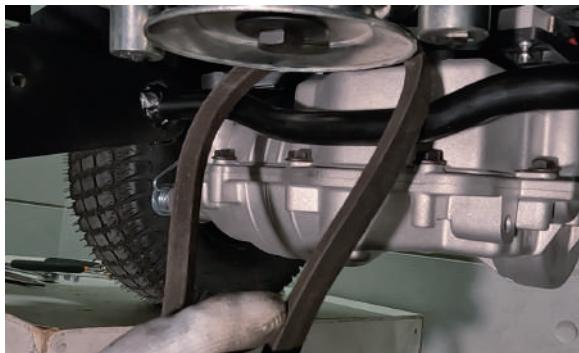
9 新しい走行ベルトを用意し、取外しの逆の手順で取付けます。
