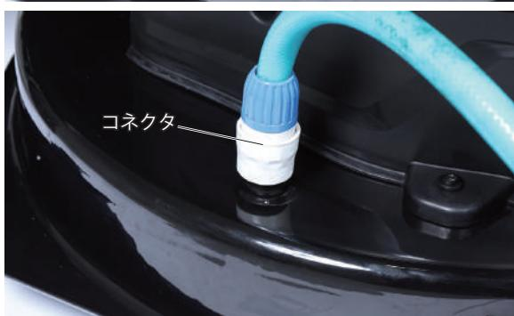
**2** 蛇口をひねり水を出したら、エンジンを始動し、ブレードを回転させ、刈刃ハウジング内を洗浄します。(水圧ですべての汚れが除去できるわけではありません。)
