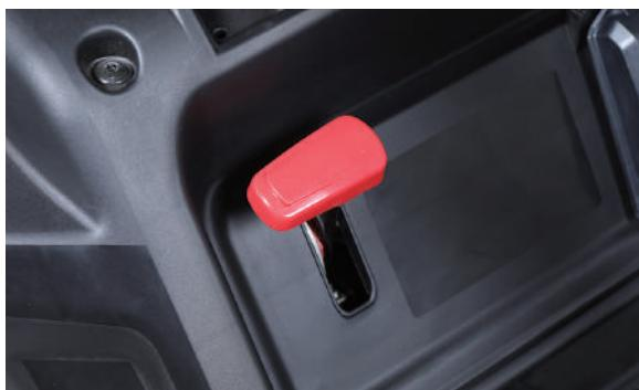
**3** 傾斜面では、走行変速レバーを「1速」にします。
