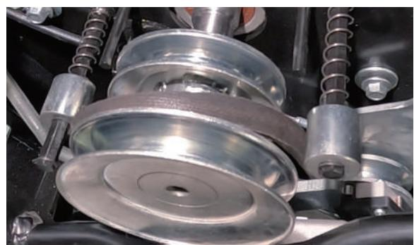
**6** 後ろの金属カバーを取り外し、プーリーのスナップリングをスナップリングプライヤーで取外します。
