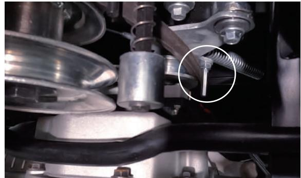
**5** インパクトレンチでプーリーのボルト、ワッシャを取り外し、2カ所のローラーを持上げ、ベルトを取り外します。
