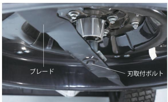
**7** 17mm のラチェットレンチ等で反時計回りで刃取付ボルト、ワッシャ、ブレードを取り外します。その際、横排出力バーを開け、片手をその穴から通すとブレードを握りやすくなります。
