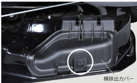
2 横排出ガイドのフックを横排出カバーのシャフトに引っ掛けます。このとき、横排出ガイドの穴が刃ハウジングの突起部分にはまっていることを確認してください。
