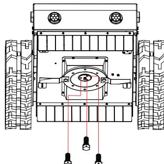
**3** 回転プレートの中心のボルトと押さえ板を14mmのレンチで取外します。
