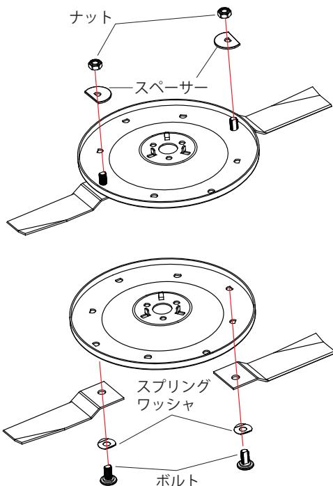
**5** 新しい回転刃を交換して、取外しと逆の手順で取り付けます。
