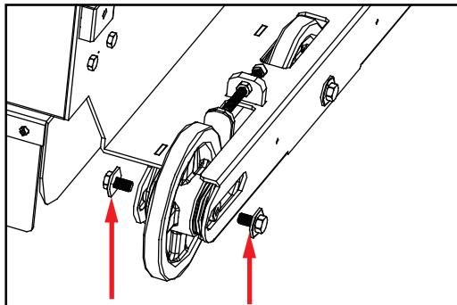
2 ボルトに付いている右側のナットを14mmのレンチでゆるめます。
