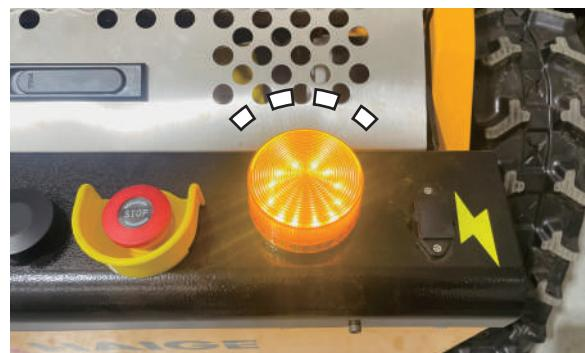
2 コントローラーの起動 / 停止ボタンを「ON」にします。
