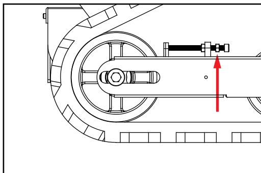
3 ボルトに付いている左側のナットを14mmのレンチでゆるめます。
