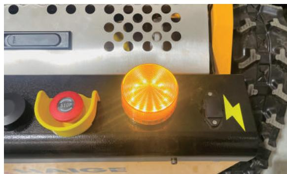
起動ランプが点灯に変わらない場合は、本体とコントローラーのペアリングができていない可能性があります。P.17 の「本機とコントローラーのペアリング」を参照してください。
