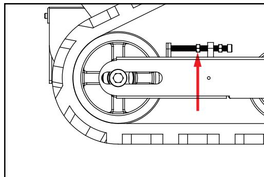
4 調整したい位置までボルトを右側へずらします。
