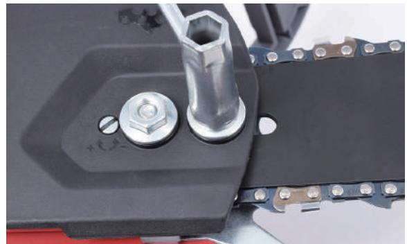
**10** ソーチェンの張りの調整を行った後にチェンカバーナットを均等に締付けます。(ソーチェンの張りの調整 P.14 参照)
