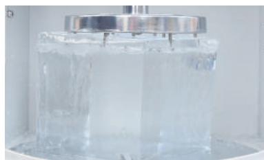
ブロックアイスを氷台に置く場合、ブロックアイスの重心が中心にないと本体が振動したり、回転に偏りが生まれたりしてしまい、螺旋軸がぶれ、ギヤを破損させてしまいます。
