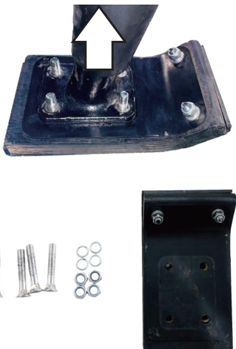
**3** 新しいフート板(衝撃板)の外側からボルトを通し、きつい場合はプラスチックハンマー等で軽く叩き、隙間がないようにはめ込みます。
