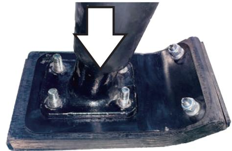
**5** 取外しと逆の手順でワッシャ、ナットを取付け、4本を均等に締付けます。
