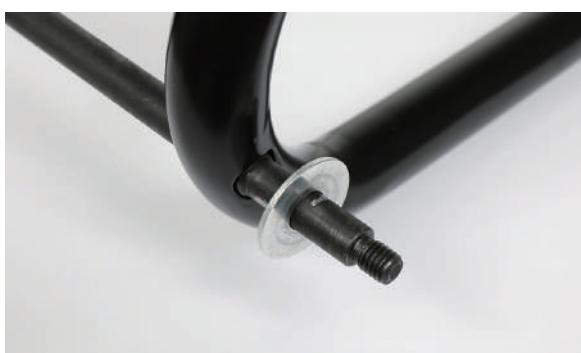
**7** 反対側の車軸からナット、ワッシャ 2 枚を取り外します。
