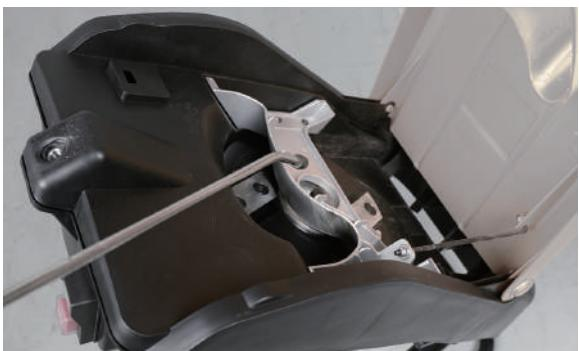
**7** 刃や回転部分に潤滑剤を塗布します。刃にヤニが付着している場合は取除きます。（P.19 参照）
