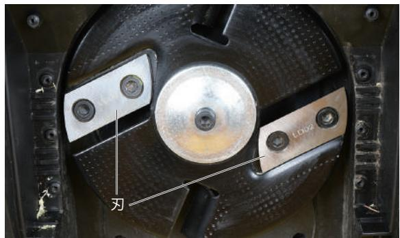
7 回転プレートが回らないように、固定穴にドライバー等を挿込み、その状態で六角レンチで刃の六角ボルトを取外します。
