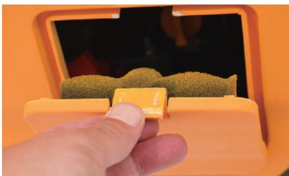
4 オイル給油キャップを取付け一旦締付け、再度外します。
