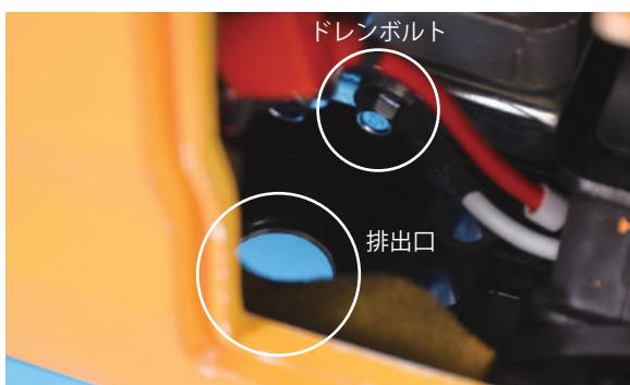
市販のオイルチェンジャーでオイル給油口から抜くことも出来ますが、若干オイルは残ります。完全に抜く場合は、ドレンボルトより抜いてください。(使用方法はオイルチェンジャーの取扱説明書をご覧ください。)
