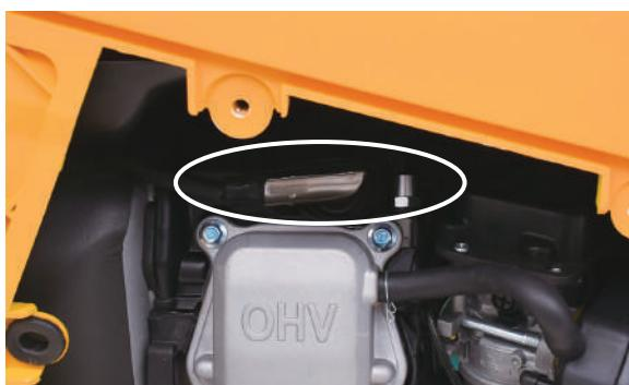
**2** プラグキャップを取り外し、付属のプラグレンチで、反時計回りに回し点火プラグを取り外します。
