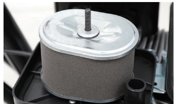
**2** エアフィルタを取り外し、汚れをエアブロー等で吹き飛ばします。汚れがひどい場合は、中性洗剤入のぬるま湯で丁寧に洗い、よく乾燥させます。
