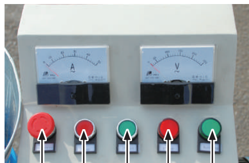
緊急停止 スイッチ スタート スイッチ 稼働ランプ 停止 スイッチ 電源ランプ
