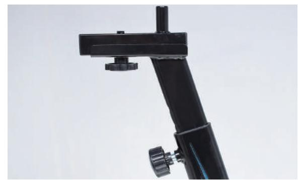
**3** ノブでサドル調整チューブを固定し、サドルをサドル調整チューブに挿込みます。挿込みにくい場合は、サドルのやぐらのナットを 13 mmのスパナで緩めます。
