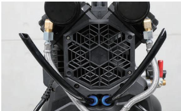
**2** エアフィルタを反時計回りに回し取外します。
