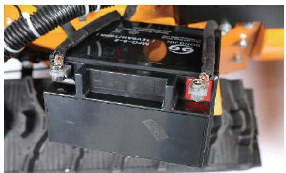
3 バッテリ端子との接続が、しっかりと固定されているか点検をします。緩んでいる場合は、しっかりと固定されるまでナットを締直します。
