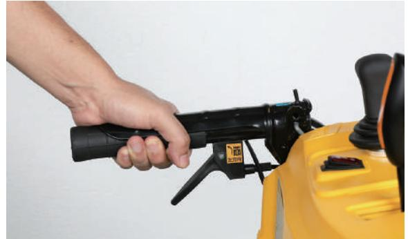
4 走行クラッチレバー、除雪クラッチレバーから手を放します。走行とオーガの回転が停止します。
