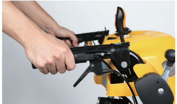
**8** 変速レバーを最適な速度の位置にします。
