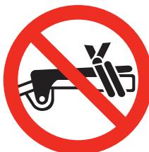
除雪クラッチレバー(デッドマンクラッチ機構)、除雪クラッチレバー(デッドマンクラッチ機構)を紐やクランプ等で固定することは絶対にお止めください。
