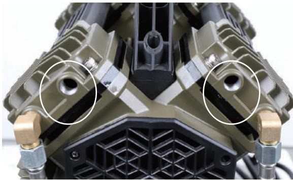
**2** 新しいエアフィルタを時計回りに回し取付けます。
