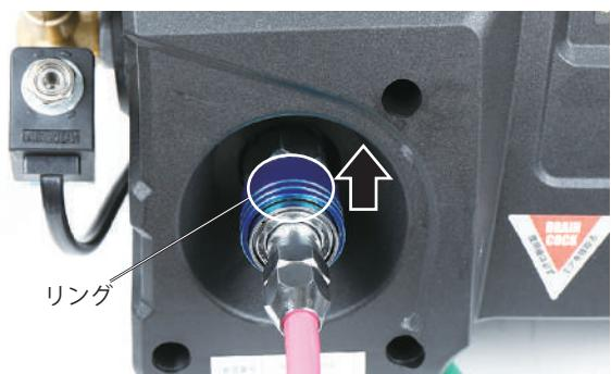
5 タンク下部にあるドレンコックをゆっくり反時計回りに回し、タンク内の圧縮空気を放出すると同時に、水抜きを行います。
