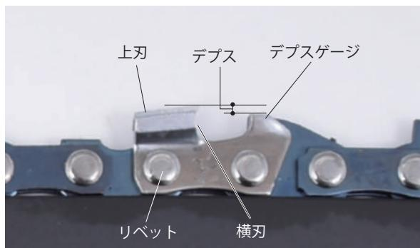
**6** 刃の欠けやドライブリンクの摩耗や曲がり、リベットの破損がないか確認します。不具合が確認されたら使用を行わずに、新しいソーチェンと交換してください。
