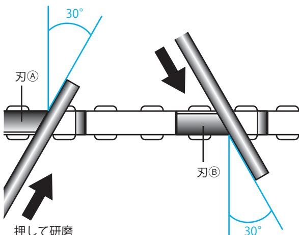
はじめに刃Ⓐを研磨し、この刃と同じ向きの刃を全て研磨します。
