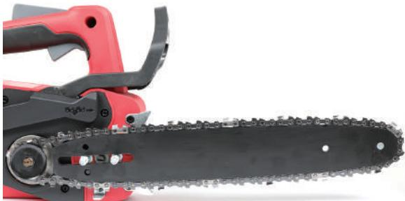
9 チェンカバーを取り付け、チェンカバーナットを2ヵ所を仮留めします。
