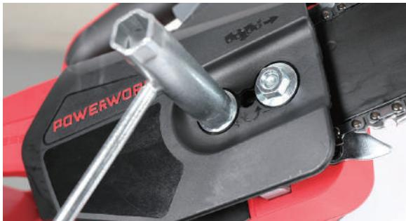
10 ソーチェンの張りの調整を行った後にチェンカバーナットを均等に締付けます。(ソーチェンの張りの調整 P.14 参照)
