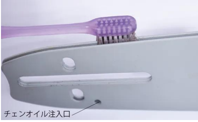
チェンオイル注入口
