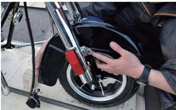
5 4カ所のボルトを取付け締付けます。
