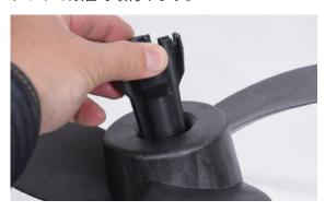
4 プロペラが回転しないよう固定して、プロペラレンチを使ってナットを締めます。ナットの締めすぎはプロペラの破損の原因となりますので注意してください。
