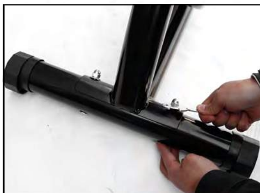
2.後ろ側の脚の土台を2つのボルトとワッシャーとナットでではめます
