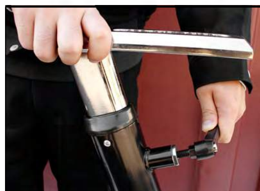
6.ハンドルのベース部分を好きな高さに合わせてL字のボルトで固定します
