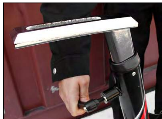
3.サドルのネック部分を好きな高さに合わせてL字のボルトで固定します (角度の広い方がサドルのネックです)
