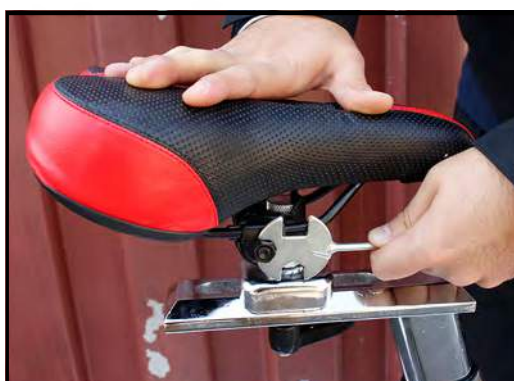
5.サドルをボルトで固定します
