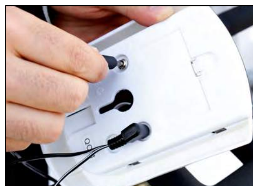
9.ハンドルから出ている線をPULSEの方に本体から出ている線をSENSORの方に繋げます
