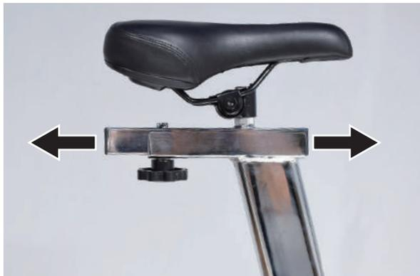
**4** 工場出荷時サドルは仮留めされています。サドルをの位置、角度を決め、13mmのスパナで左右均等に締付けます。締付けが甘いとガタツキの原因になります。
