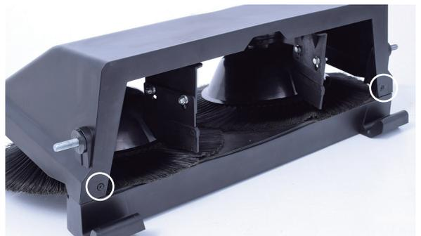
5 左右のボルトを内側に押し込み外します。ワッシャも外します。
