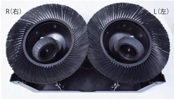
7 左右の傾斜ホイールをそれぞれ強く引き、本体から車軸ごと引抜きます。(写真はRです。)
