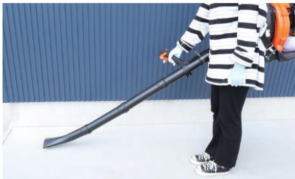
**4** アクセルトリガーを握り、風量の状況をみながら、エンジンの回転を調整します。
