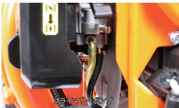
**3** チョークレバーを引上げ「閉」にします。この時、写真のように確実に上までレバーを上げてください。
