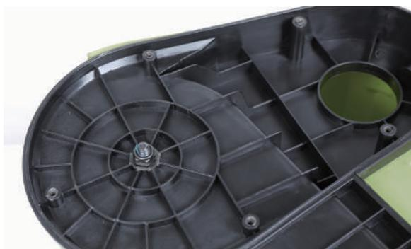
**2** 右側面のカバーのネジ6カ所を取外します。
