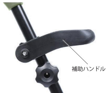
②は、補助ハンドルを逆向きにしています。この場合、補助ハンドルを固定しているノブボルトと、フレームのノブナットが干渉し締付けしにくくなるので、フレームのノブナットは逆側に取付けます。
