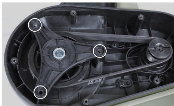
**4** 左側面のナット、ワッシャを取外します。このとき内側の車軸にもワッシャがありますので、紛失しないようご注意ください。
