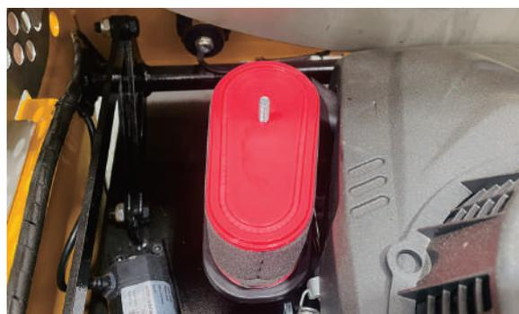
**2** スポンジを外し、エアフィルタの汚れをブロワー等で吹き飛ばします。
