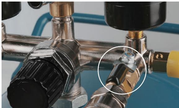
3 タンクを横にしてから、ドレンコックを開けて、空気や水を完全に抜きます。ドレンコックはタンク真下にはありませので、最後はタンクを傾けて完全に水を抜いてください。
