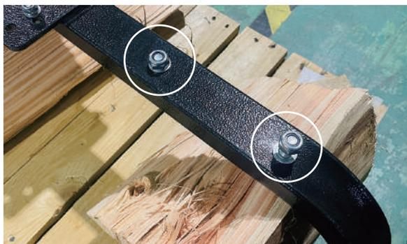
**2** ビーム/シリンダーの取付穴とホイールスタンドの取付穴を合わせます。写真のようにフォークリフトで吊ることで位置決めが簡単になります。
