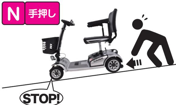
※スピードを出し過ぎると安全装置が働き、移動途中でブレーキがかかります。車両を完全に停止した状態で2秒待つと、再度移動ができますようになります。ゆっくり手押しするとブレーキはかからずに移動ができます。
