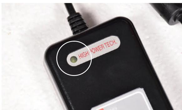
**6** バッテリーが完全に充電されたら、電源を抜いてバッテリーに繋いだコードも抜いてください。
