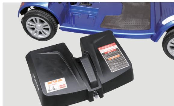
**2** バッテリーボックスの前面の3ピンの充電器ソケットに充電器のコードを挿込みます。
