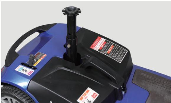
**2** シートサポートのボルト、ナットを8mmの六角レンチと17mmのスパナで取外します。
