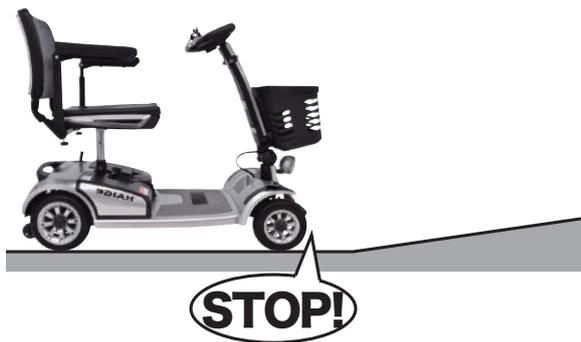
**2** 下り坂では、安全のためスピードを低速にし走行します。スピードが速すぎる場合は、アクセルレバーから指を放し停車します。再度低速で発進します。
