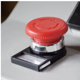
緊急停止スイッチが 押された状態
